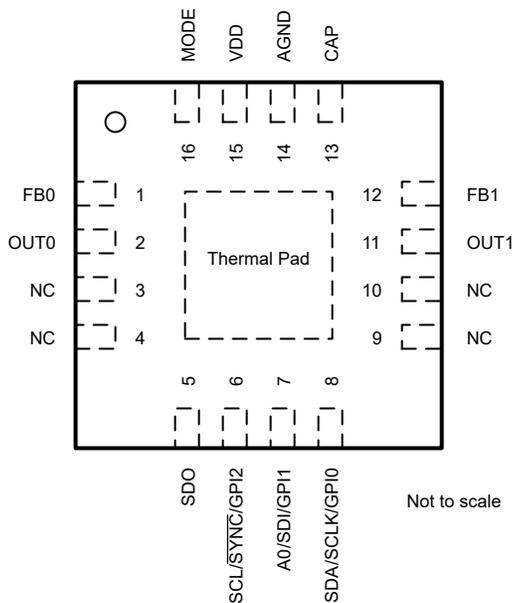
**Figure 4-1. Pin Diagram**
