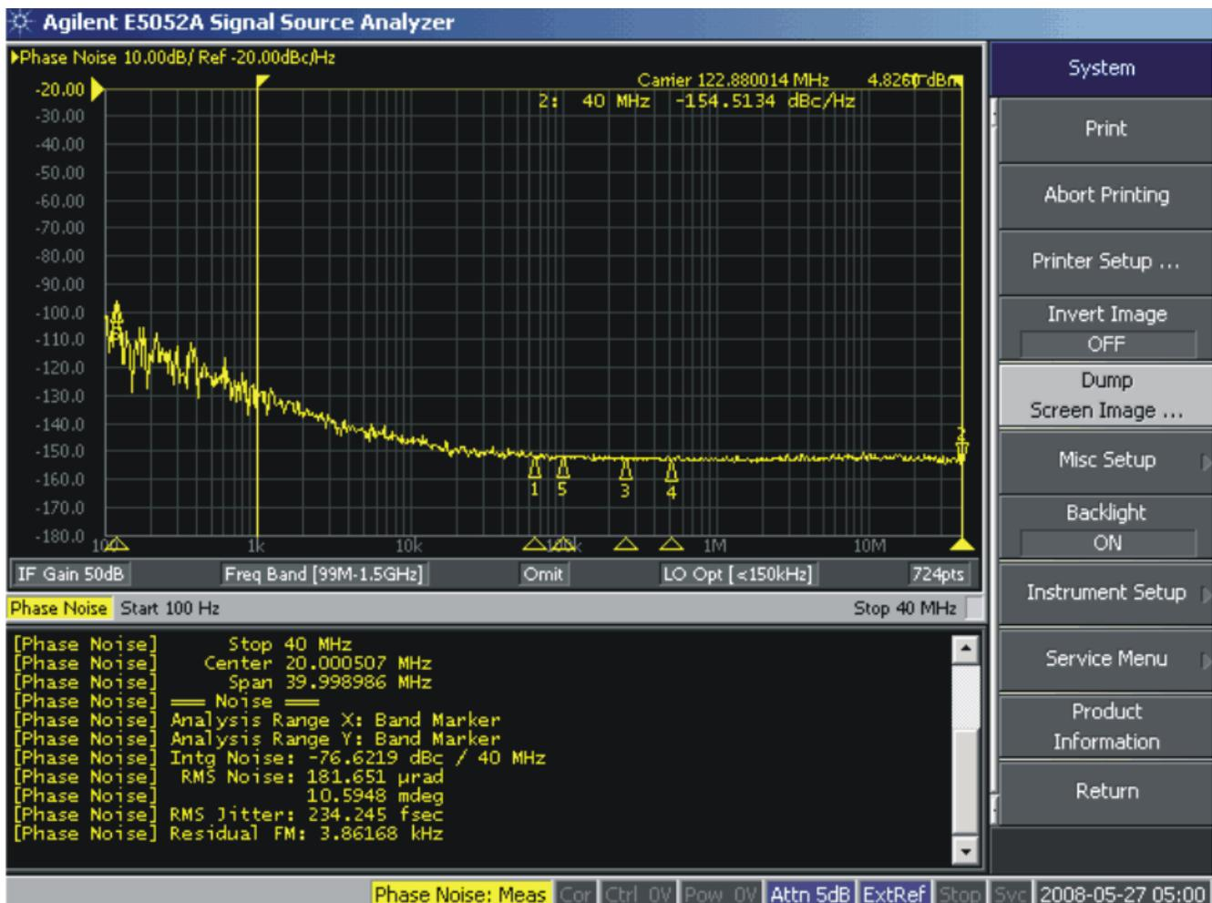
Figure 13. CDCE72010 122.88-MHz HS-LVPECL Output Phase Noise
