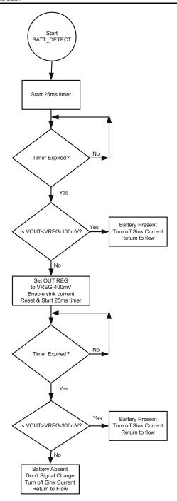
图 9-7. Battery Detect Routine
