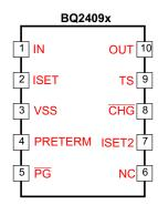
图 7-1. DGQ Package 10 Pins Top View
