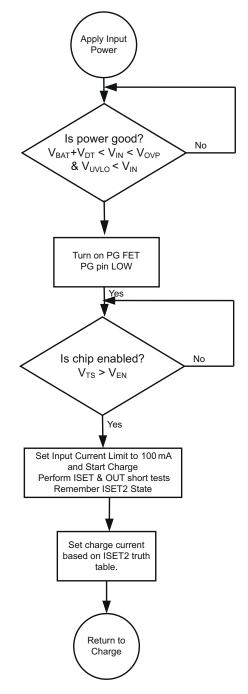
图 9-3. BQ2409x Power-Up Flow Diagram
