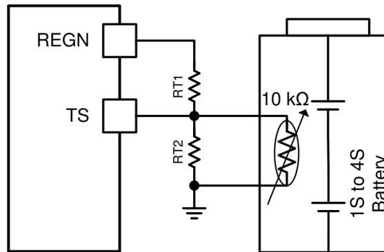
图 8-10. TS Resistor Network
