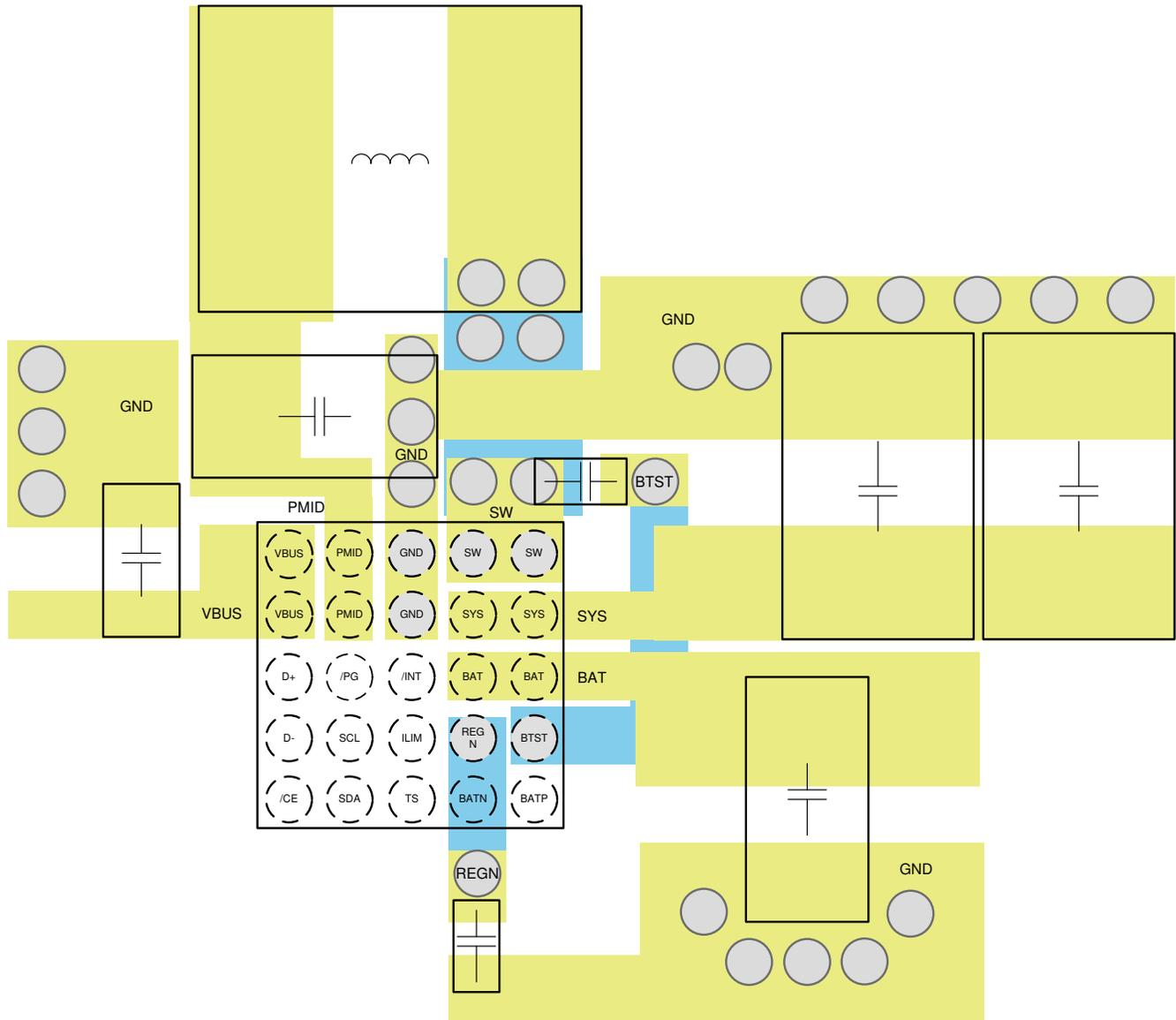
图 11-2. PCB Layout Example
