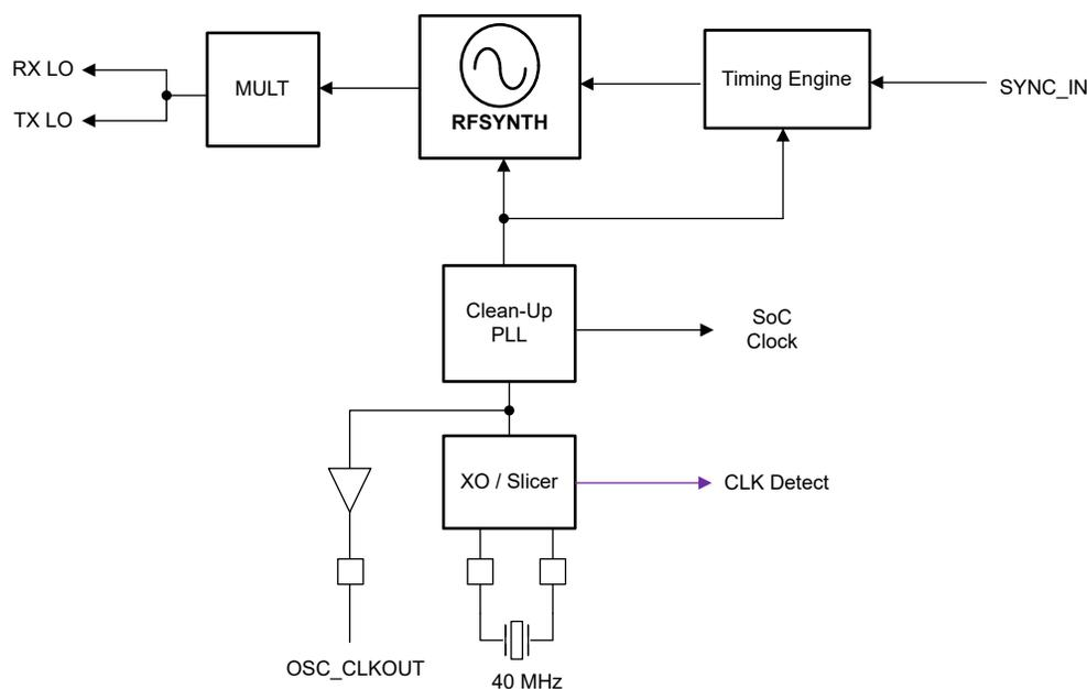
**Figure 8-1. Clock Subsystem**
