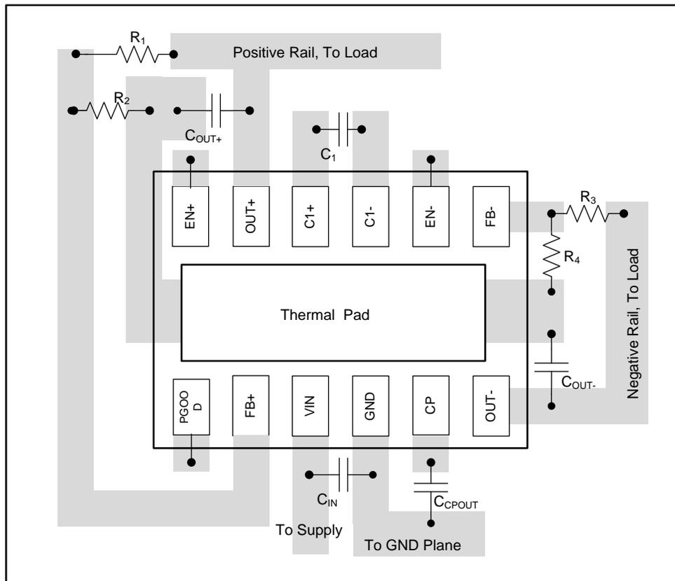
**图 16. LM27762 Layout Example**
