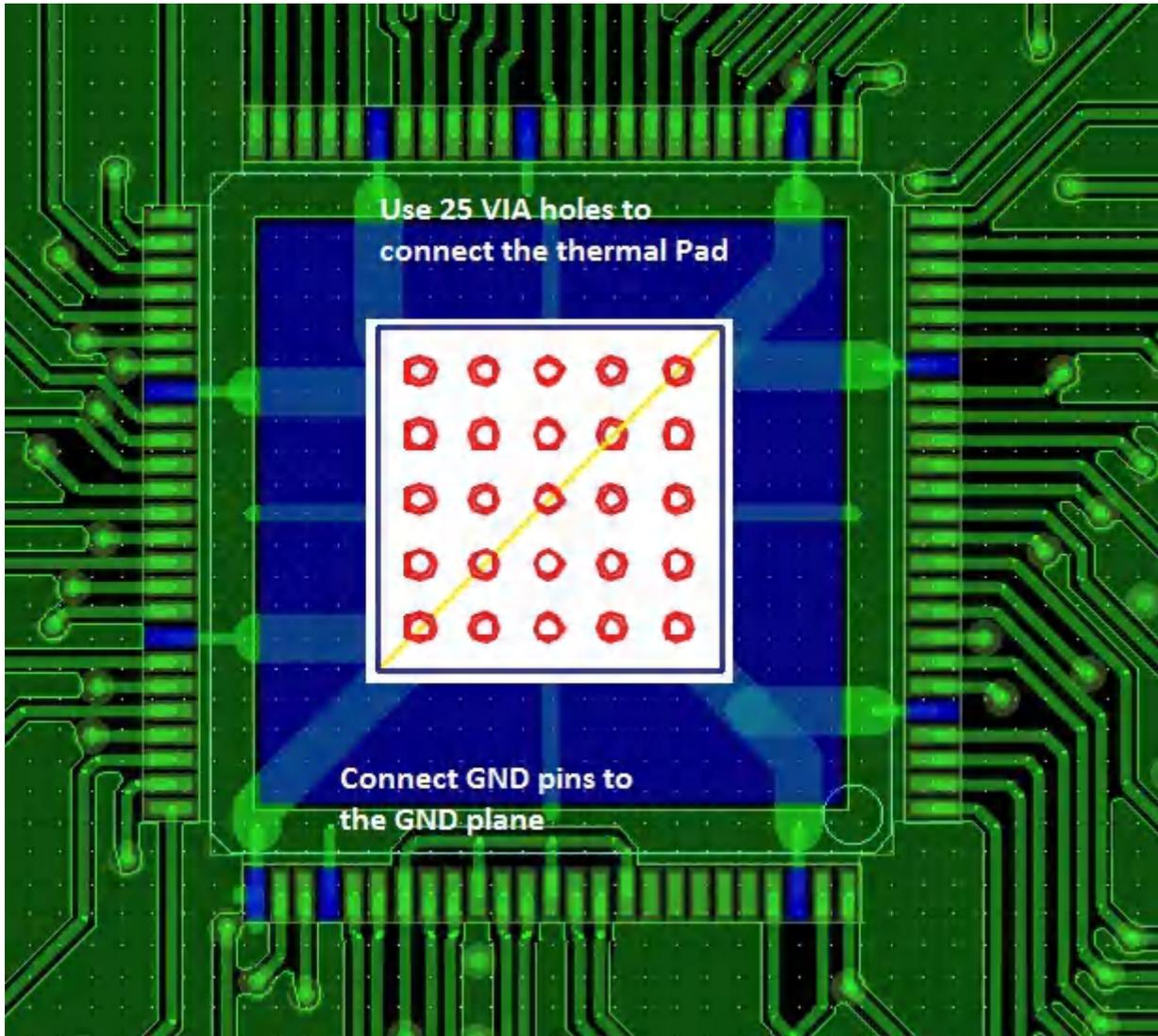
图 12-4. Ground Routing
