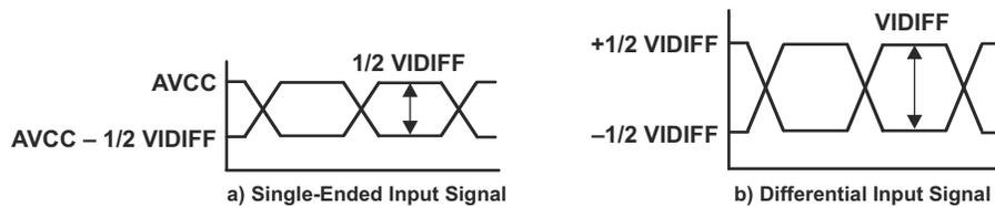
图 9-2. TMDS Inputs
