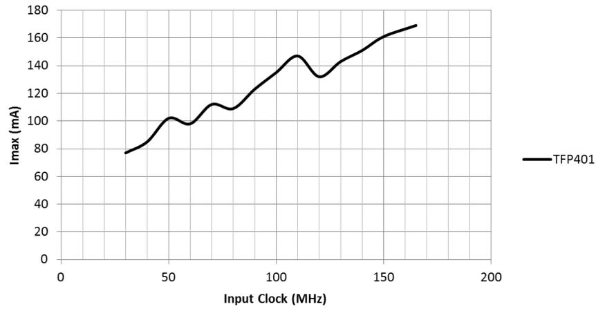
图 7-1.  $I_{max}$  vs Input Frequency
