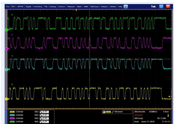
THVD2450 V_{CC} = 3.3V R_L = 50\ \Omega 50Mbps 速率下的随机 (PRBS7) 数据
