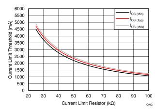
图 9-2. Current-Limit vs R<sub>(ILIM)</sub>
