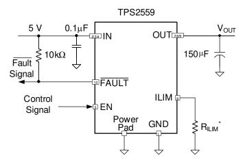
图 9-1. Typical TPS2559 Power Switch
