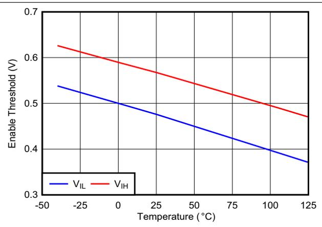
图 6-4. EN Threshold vs Temperature
