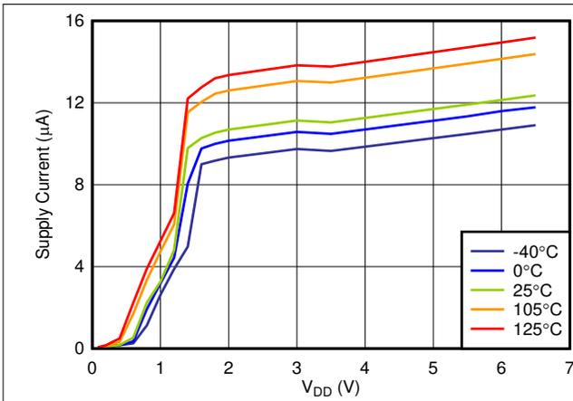
图 6-3. Supply Current vs V<sub>DD</sub>
