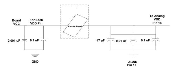
Figure 12. CDCV857/CDCV857A/CDCV855 Filter Circuit
