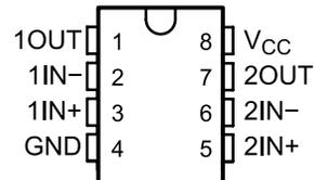
图 9. LM2903 Pinout Diagram
