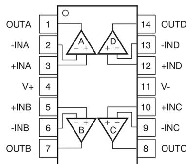
图 4. OPA4314 Pinout Diagram
