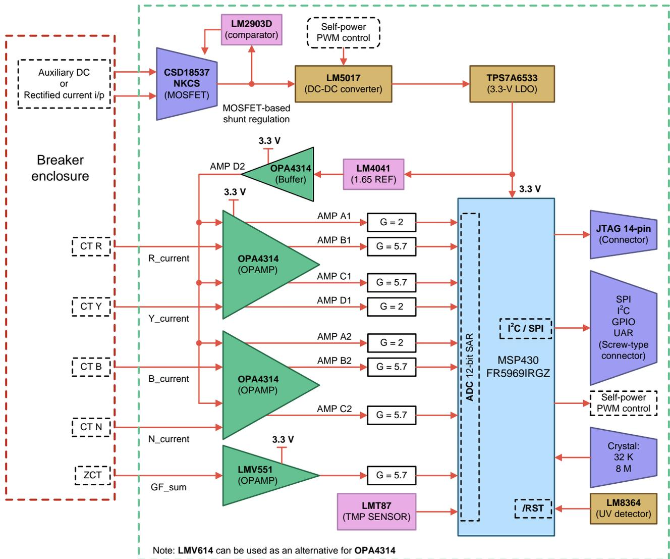
图 2. TIDA-00498 Block Diagram
