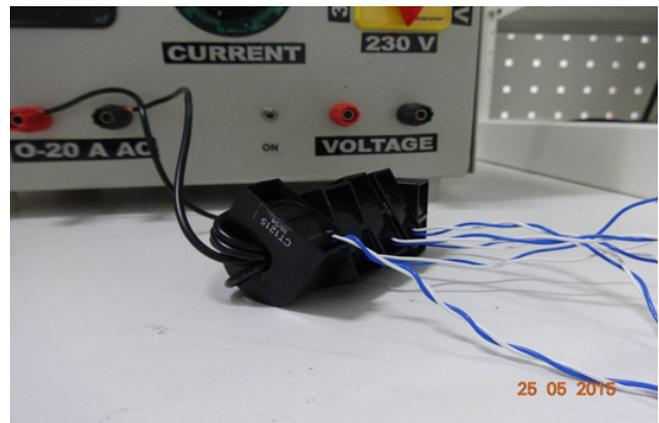
图 25. Current Transformer
