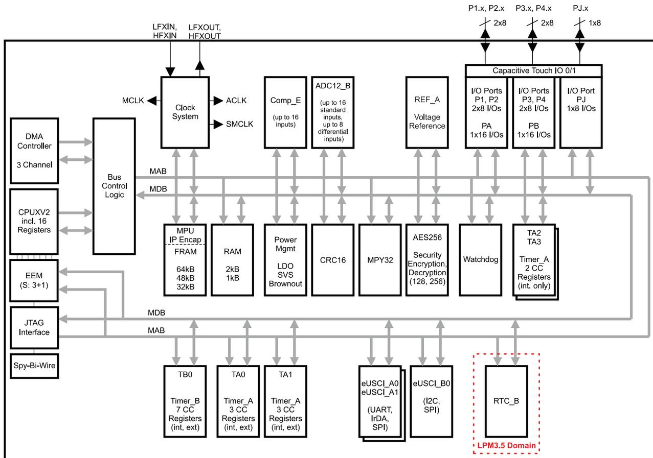
图 3. MSP430 System Block Diagram
