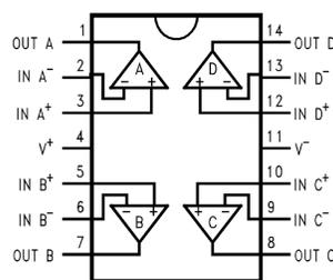
图 5. LMV614 Pinout Diagram
