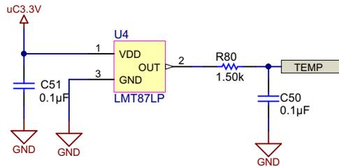
图 21. Temperature Sensor Schematic
