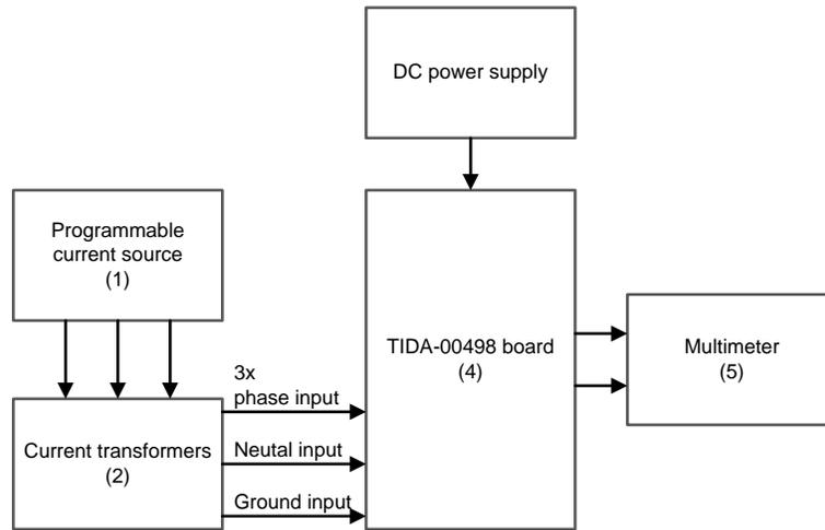
图 23. Test Setup Block Diagram
