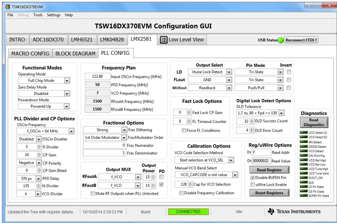
Figure 14. LMX2581 PLL Config Tab
