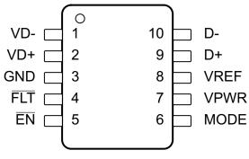
Figure 1. Pinout of TPD2S701-Q1 and TPD2S703-Q1
