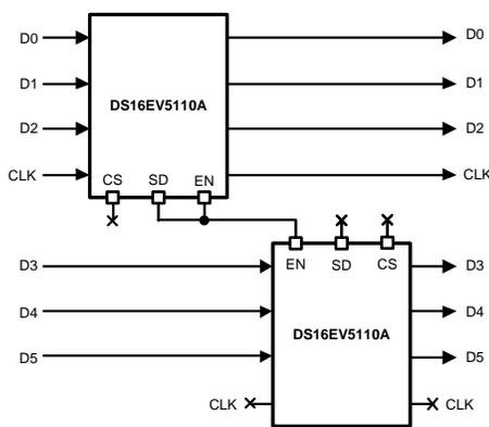
**Figure 15. 2 DS16EV5110A in a DVI Dual Link Application**
