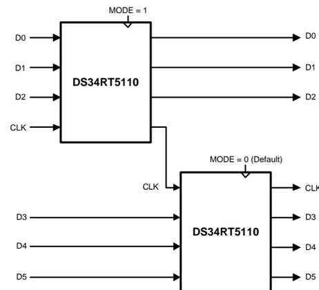
**Figure 16. 2 DS34RT5110 in a DVI Dual Link Application**
