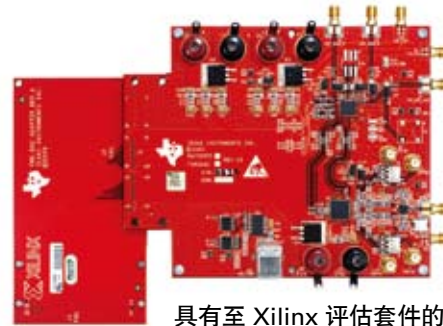
具有至 Xilinx 评估套件的 FMC-DAC-转接卡连接线的 TI DAC 评估板
