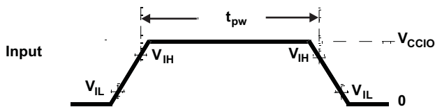
图 4-2. TTL - 电平输入
