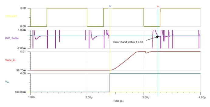
图 20. TINA-TI™ Simulation Result—ADC Input Settling Rising
