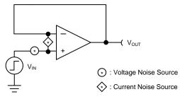
图 13. Intrinsic Noise of Input Driver
