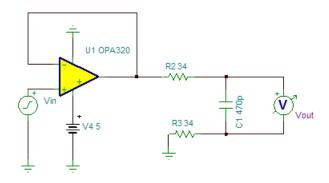
图 24. TINA-TI™ Schematic—Checking Input Driver Noise
