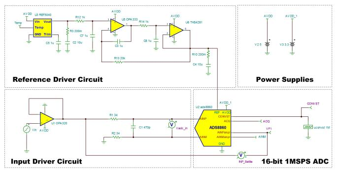
图 19. TINA-TI<sup>™</sup> Schematic—Complete DAQ Block
