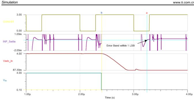
图 21. TINA-TI™ Simulation Result—ADC Input Settling Falling
