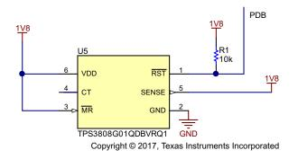
图 10. PDB Startup Delay Circuitry
