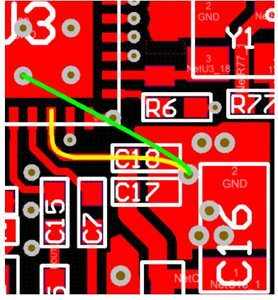
图 17. Decoupling Current Loop
