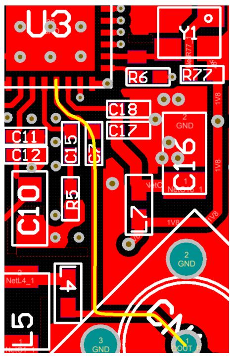
图 18. High-Speed Serial Trace
