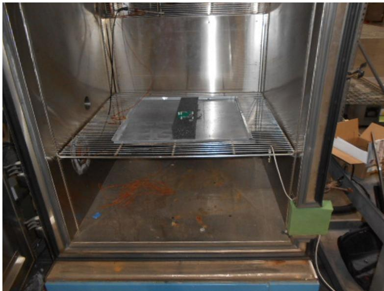
图 18. 无线 PIR 运动检测器温度及湿度测试装置
