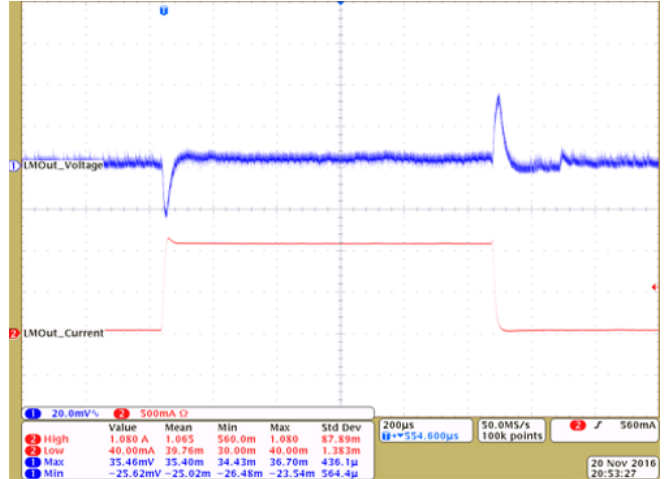
图 41. TLV62080 瞬态响应 (0 到 1A)
