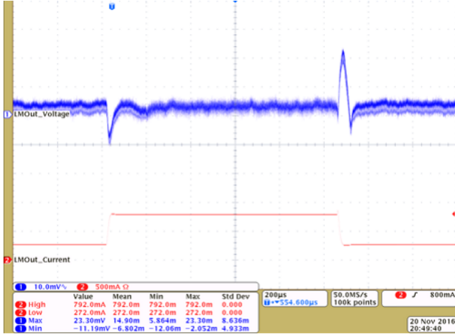
图 40. TLV61080 瞬态响应 (250 到 750mA)
