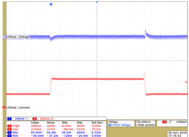
图 38. LM5166 瞬态响应 (200 到 480mA)
