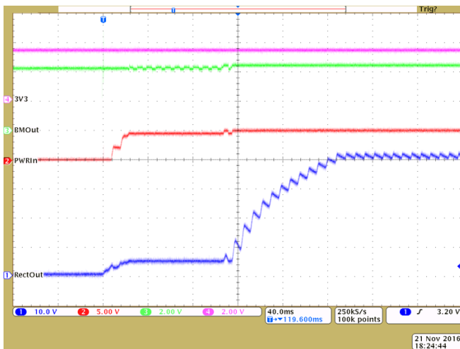
图 25. 30V 交流电源启动
