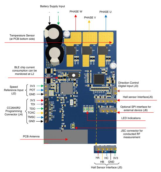
图 15. TIDA-01516 PCB Connectors
