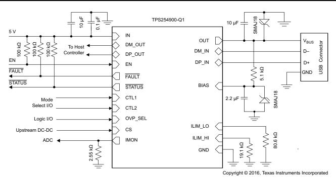
图 11. TPS254900-Q1 Simplified Circuit
