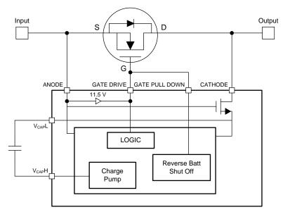
图 8. LM74610-Q1 Functional Block Diagram
