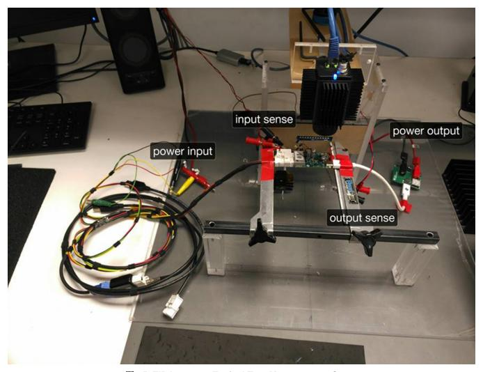
图 25. TIDA-01432—Typical Test Measurement Setup
