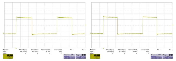
图 30. V<sub>IN</sub> = 14.5 V, f<sub>sw</sub> = 400 kHz (≈2500-ns Period)—No Load
