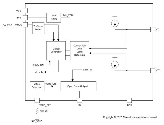
图 4. TUSB319-Q1 Functional Block Diagram
