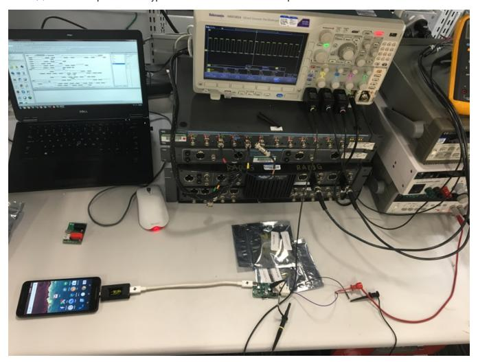
图 19. Typical TIDA-01432 Hardware Setup
