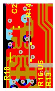
图 23. USB Type-C™ Controller Layout
