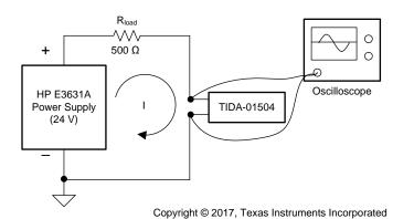
图 13. Test Setup of HART Waveform
