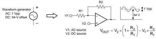
图 19. Difference Amplifier Circuit
