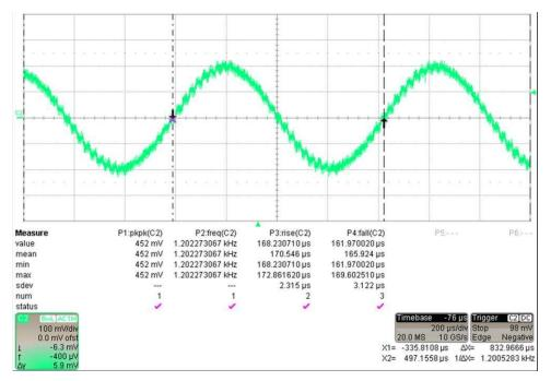
图 14. 1.2-kHz HART Wave Signal
