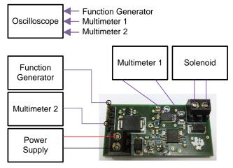
图 7. TIDA-01506 Hardware Setup
