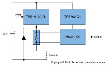
图 1. TIDA-01506 Block Diagram
