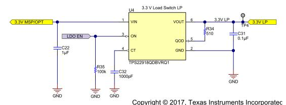
图 12. TIDA-01008 Schematic: TPS22918-Q1
