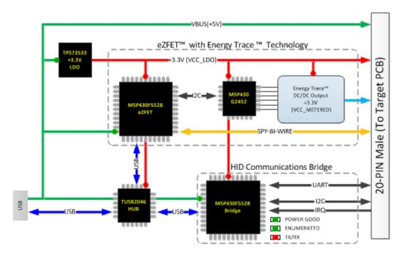
图 23. CAPTIVATE-PGMR PCB Block Diagram
