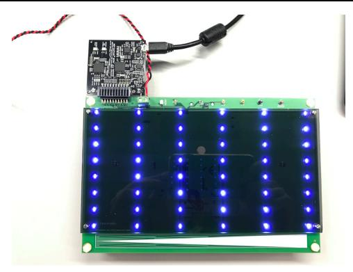
图 21. TIDA-01008 With Acrylic Light Attenuator
