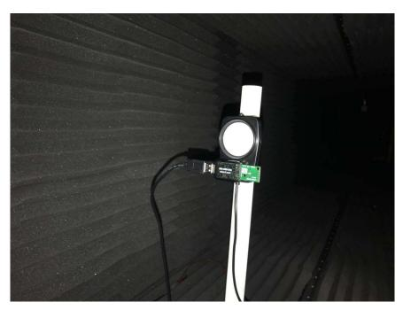
图 31. TIDA-01008 Light Meter and OPT3001 EVM Test Setup
