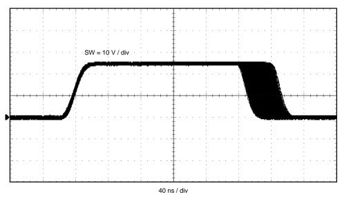
图 36. TIDA-01008 Switch Node Spread Spectrum
