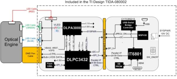
图 1. TIDA-080002 Block Diagram
