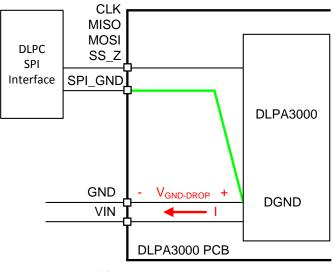
图 6. SPI Connections
