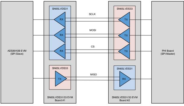
图 2. TIDA-060017 Block Diagram
