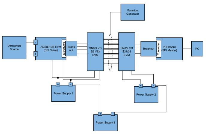
图 11. SPI Over LVDS Test Setup
