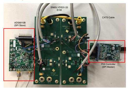
图 9. Hardware Setup
