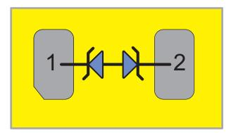
图 8. TPD1E10B06 Functional Block Diagram
