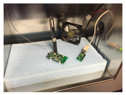
图 17. Relative Humidity Test Setup
