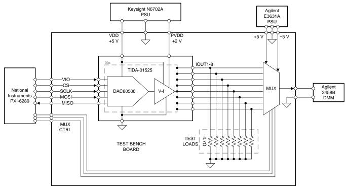
图 8. Test Setup Block Diagram
