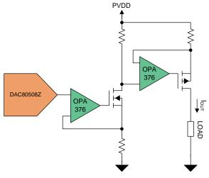
图 1. TIDA-01525 Block Diagram
