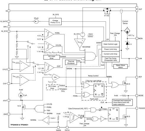
图 3. TPS26630 Block Diagram
