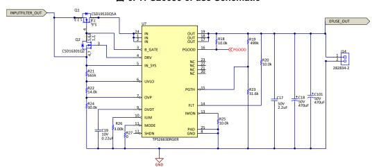
图 6. TPS26630 eFuse Schematic
