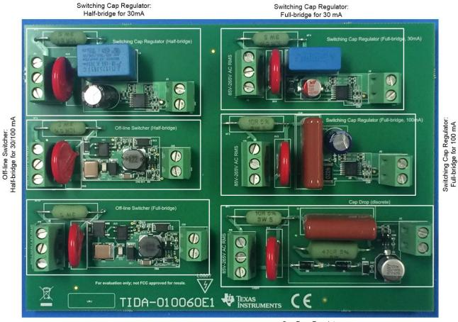
图 10. TIDA-010060 Board Setup
