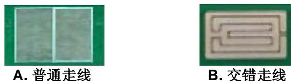
图6. 口线复用方式下的按键走线
