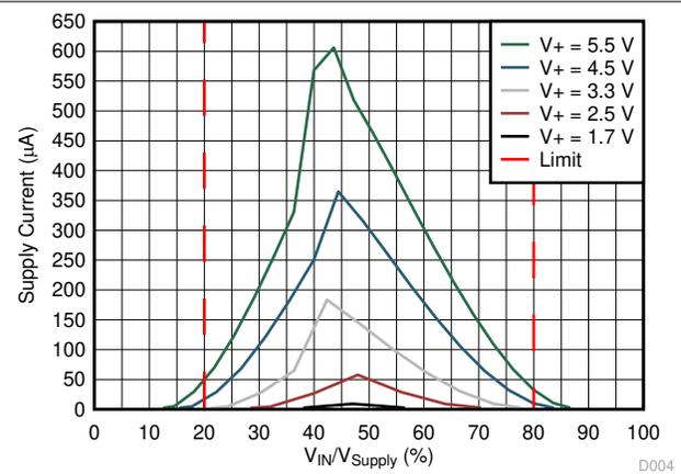
図 6-7. 電源電流と入力セル電圧との関係
