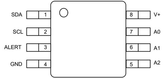
図 5-2. DGK パッケージ 8 ピン VSSOP 上面図
