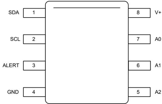
図 5-1. D パッケージ、8 ピン SOIC (上面図)
