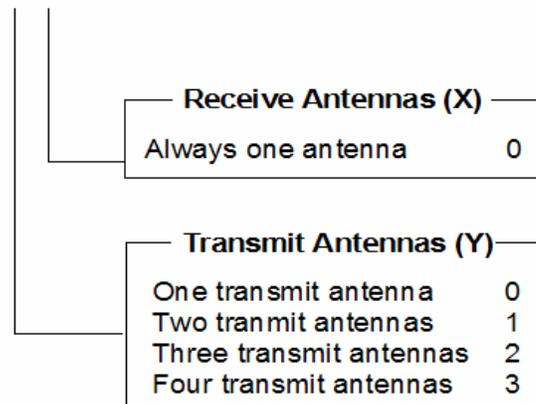
**Figure 16. MUX Antennas**
