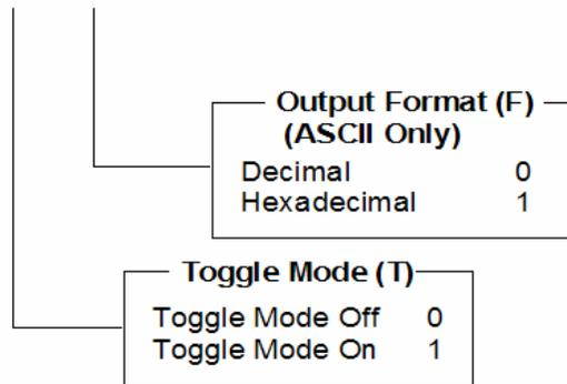
**Figure 14. ASCII Protocol Control Byte**
