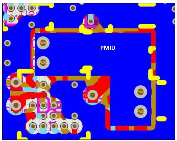
Figure 12. PMID Plane in Bottom Layer
