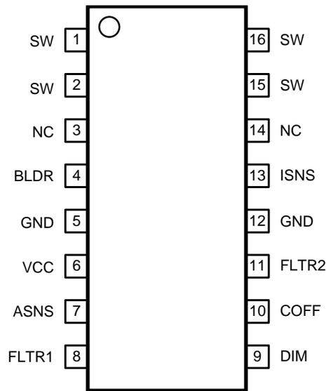
**Figure 19. Device Pin-Out**
