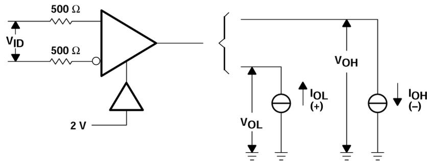
Figure 6-1.  $V_{OH}$ ,  $V_{OL}$
