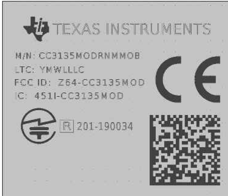
图 9-1. SimpleLink™ CC3135 Module Markings
