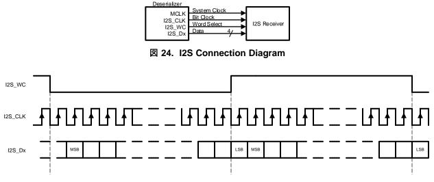
図 25. I2S Frame Timing Diagram
