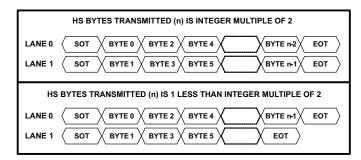
図 15. 2 MIPI<sup>®</sup> Data Lane Configuration
