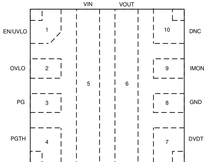
図 5-1. LM73100 RPW Package 10-Pin QFN Top View
