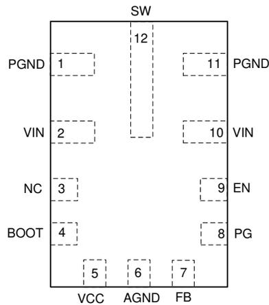
图 6-1. 12-Pin VQFN RNX Package (Top View)
