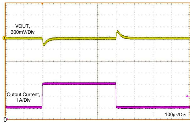
$V_{IN} = 12\text{ V}$        $V_{OUT} = 5\text{ V}$
