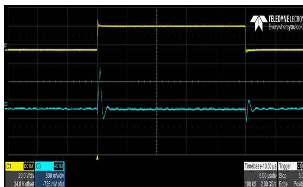
図 2. コモンモード入力電圧 V_{CM} の大きなステップ波形によって発生する出力グリッチの代表的な波形
