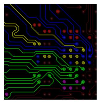
Data byte routing Layer 3 Most of Byte lanes 1 & 3 Byte lane 0 – Red Byte lane 1 – Blue Byte lane 2 - Yellow Byte lane 3 – Green Check Byte - Violet
