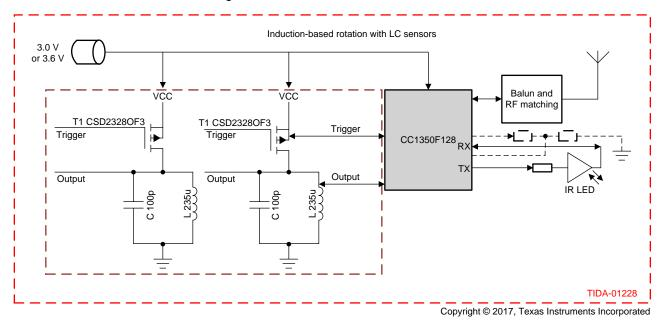
図 1. TIDA-01228 Block Diagram
