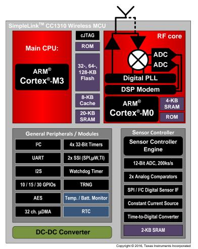
図 2. CC1350 Block Diagram
