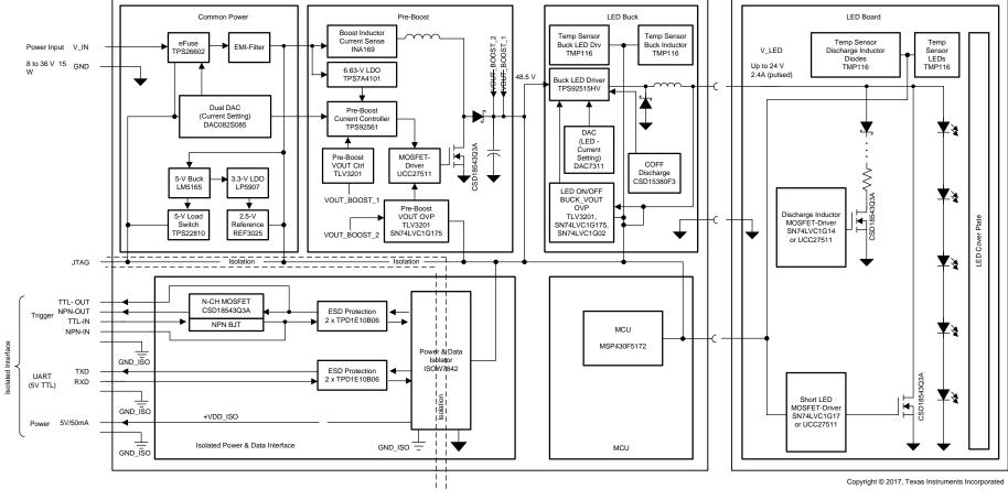
図 1. TIDA-01081 Block Diagram
