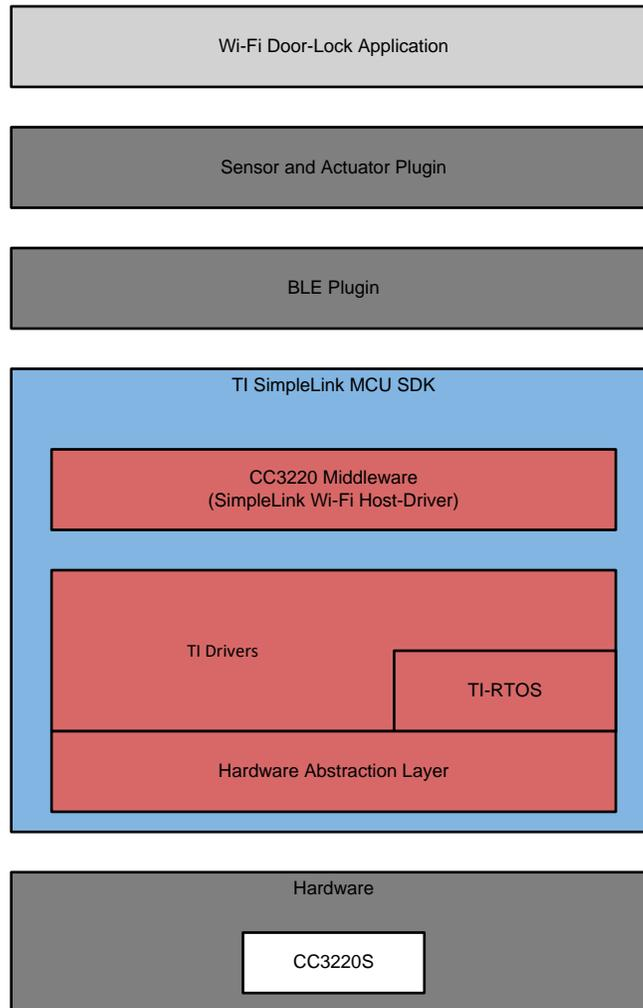
**図 3. Wi-Fi, Door-Lock Software Block Diagram**
