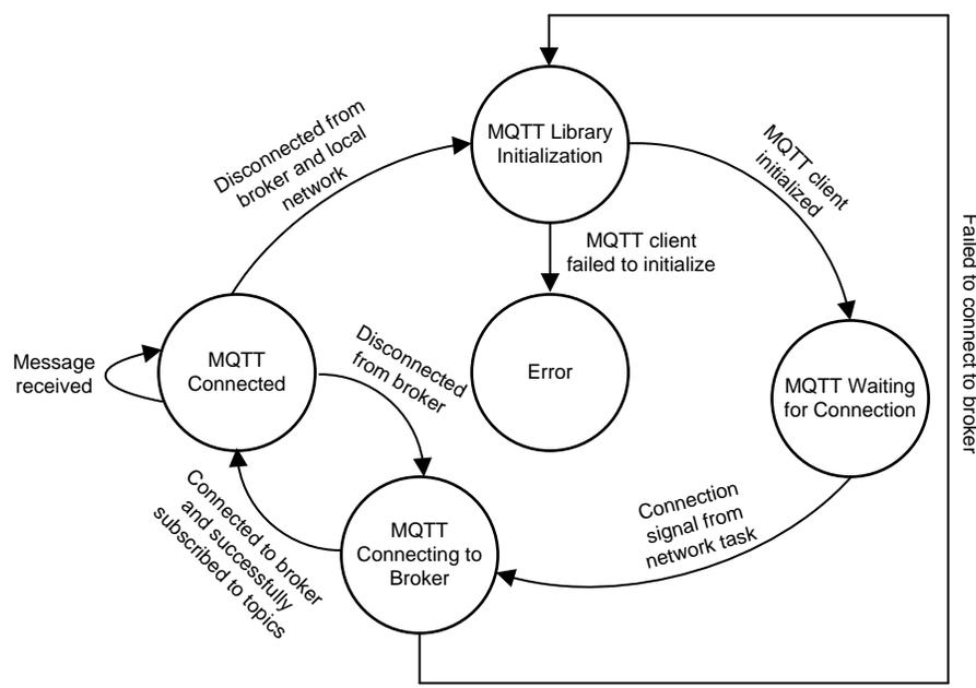
図 8. MQTT Thread Main Loop
