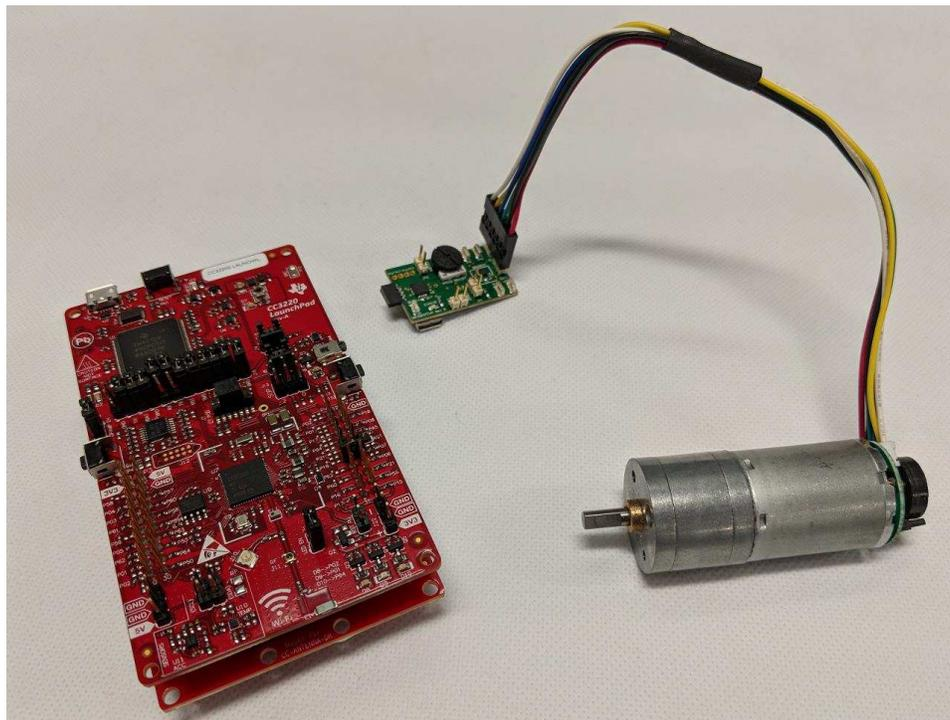
図 15. LaunchPad™ and BoosterPack™ Stackup
