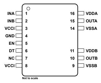
Figure 4-1. Pin Diagram
