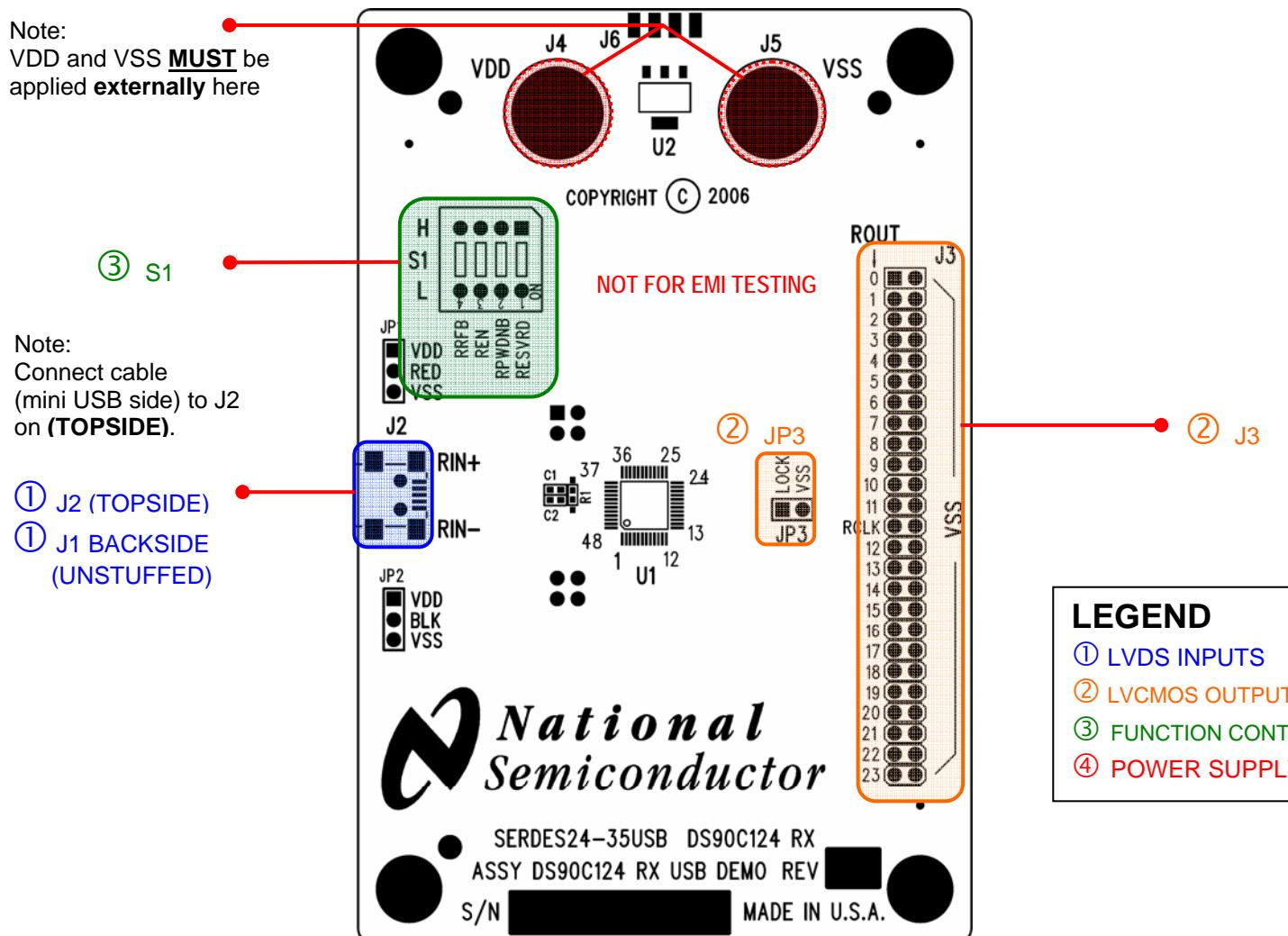
Figure 3. DS90C124 Rx Evaluation Board
