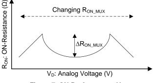
Figure 7. ON-Resistance vs V<sub>D</sub>
